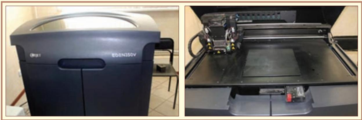
**Рис. 1.** 3D-принтер Object Eden 350V. Слева – общий вид принтера, справа – рабочая область
